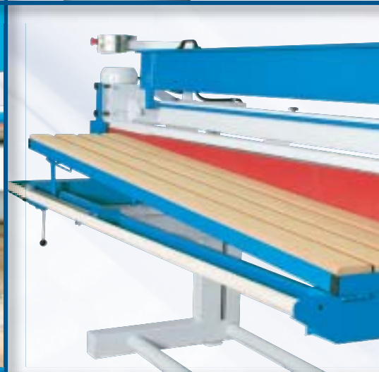
Podélné sklápění pracovního stolu pro broušení hran ■ Wzdłużne przechylenie stołu
