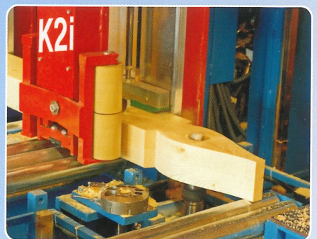
Bohrungen verschiedenster Größe sowie auch Sacklochbohrungen.
