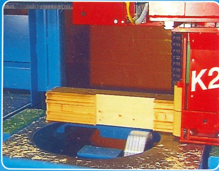
Ausblattungen in jedem Winkel auf allen 4 Bauteilseiten.
