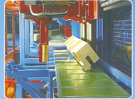
Positionsgenaues Umkanten - vollautomatisch.
