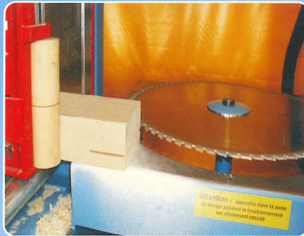
Schlitz bis zu 300 mm Tiefe werden mit der Horizontalsäge sauber und schnell ausgeführt.
