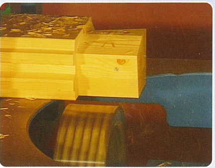
Profiliertes Holz wird verletzungsfrei transportiert und bearbeitet, z.B. beim Fräsen von Blockbohlen
