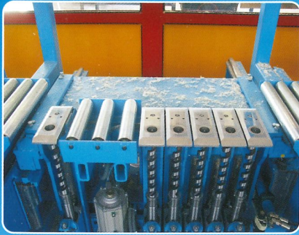
Mehrfachbohrgerät - vertikal. Mit 6 Bohrern bestückt, können auch alle 6 Bohrungen gleichzeitig ausgeführt werden. Die max. Bohrtiefe beträgt 300 mm. Bohrerdurchmesser von 6 - 60 mm.
