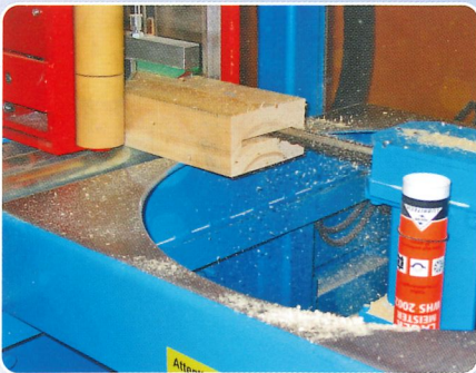
Verdeckte oder winkelige Schlitz sind mit dem schwenkbaren Kettenschlitzgerät einfach zu realisieren (360°).
