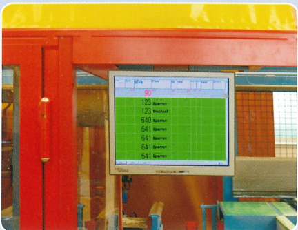
Zusätzliche Anzeige der gefertigten Bauteile am Ablagepunkt
