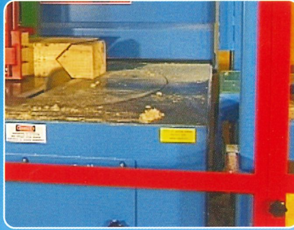
Hexenschnitte mit beliebigen Schnittwinkeln und Schnitttiefen.
