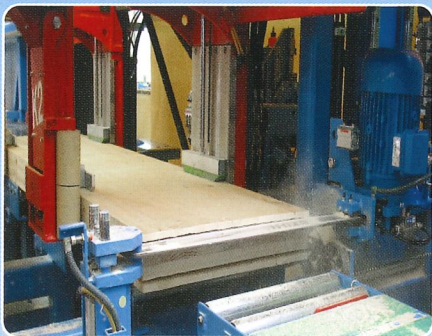
Mit dem geführten Kettenschlitzgerät sind Schlitz bis zu einer Bauteilbreite von 625 mm in beliebiger Länge, sowie verdeckte Schlitz auf der Anschlagseite genau und schnell zu fertigen.
