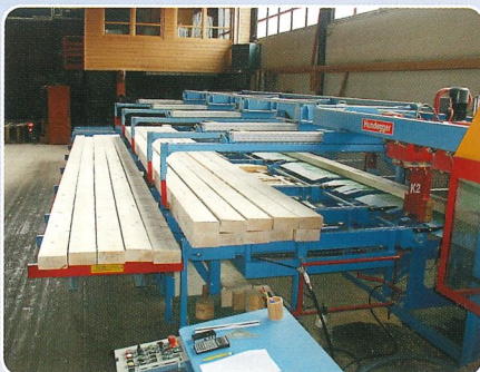
Hydraulischer Hubtisch mit automatische Paketentstapelung.
