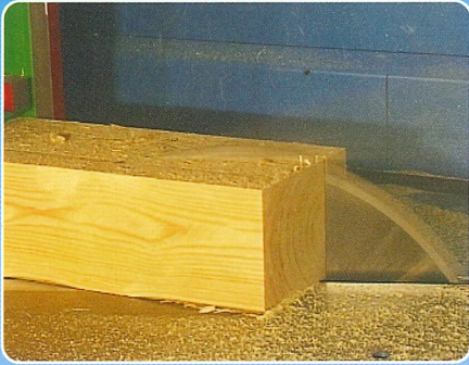
Verjüngungsschnitte in beliebiger Länge und Winkel.
