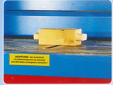
Kurze Hölzer ab 35 cm können automatisch bearbeitet werden.
