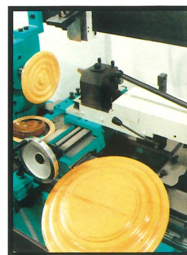
Grupo opcional para torner frontalmente. Optional unit for frontal turning. Groupe permettant de tourner de face en option. Die wahlweise installierbare Einheit zum frontalen Drehen.
