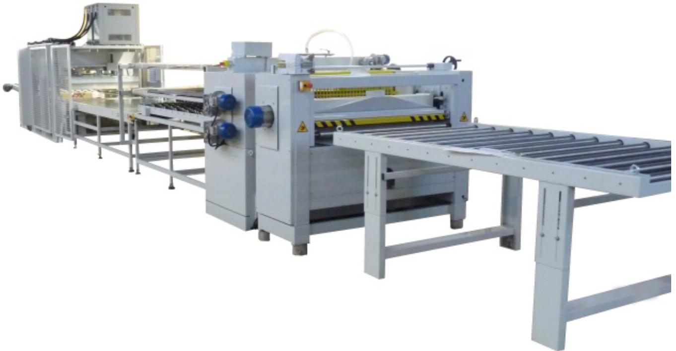
Fertigungsstraße mit Rollenbahn 3000 x 1300 mm, Bürstmaschine BM 1300, Leimauftragsmaschine LAM/2 1300, überführende Messerscheibenrollenbahn MSRB 3000 x 1300 mm, Durchlaufpresse DLP 150/OK, Pressfläche 1450 x 3000 mm, wasserbeheizt, Betriebstemperatur 150°C, und automatischer Abstapelung.
