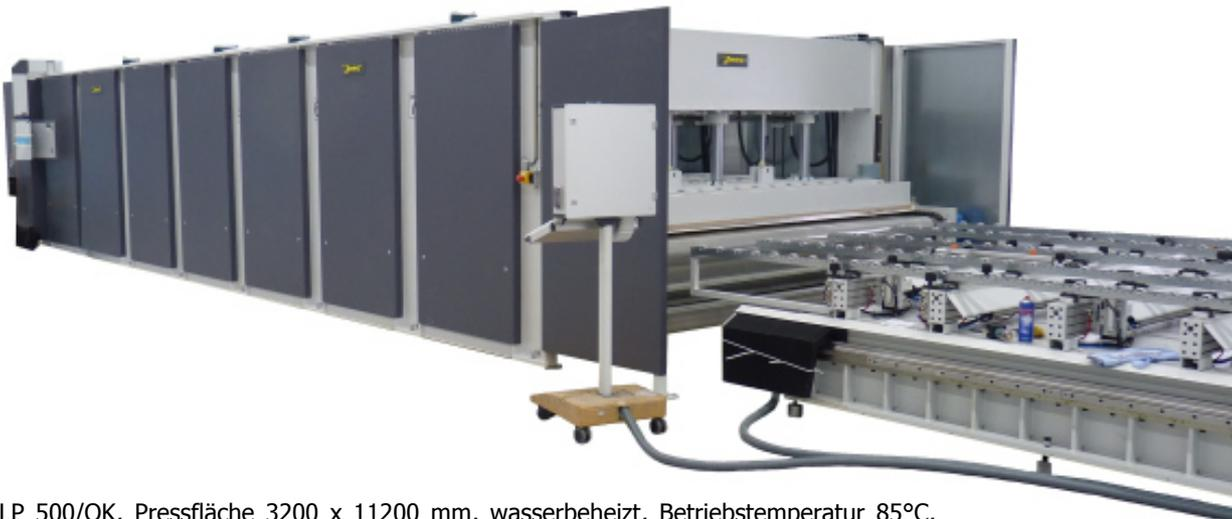
DLP 500/OK, Pressfläche 3200 x 11200 mm, wasserbeheizt, Betriebstemperatur 85°C, Hydraulikaggregat und Temperiergeräte auf dem Pressenhaupt
