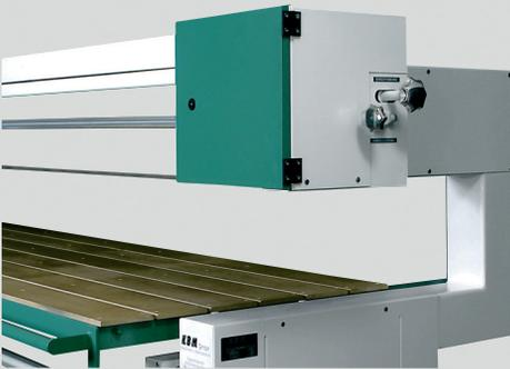
Rechter Maschinenständer mit 1000 mm tiefer Kröpfung zum Schleifen von überlangen Werkstücken, Sterngriffe zum Bandspannen und zur Bandlaufregulierung. Tischführung = Rundführung mit Prismenrollen (bei eingeschobenem Arbeitstisch keine überstehenden Maschinenteile)
