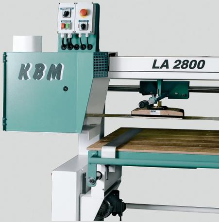
Linker Maschinenständer mit elektrischen Bedienelementen, Tür für schnellen Bandwechsel mit zusätzlichem Absauggitter und großer Absaugöffnung für die Stauberfassung, Absaugstutzen senkrecht Durchmesser 180 mm. Verstellbarer Alutischanschlag (auf Wunsch)
