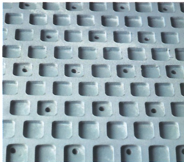
Vakuumschnecken mit Lochung des Arbeitstisches und des Transportbandes zur Fixierung kleiner Teile oder beidseitig lackierter Werkstücke
