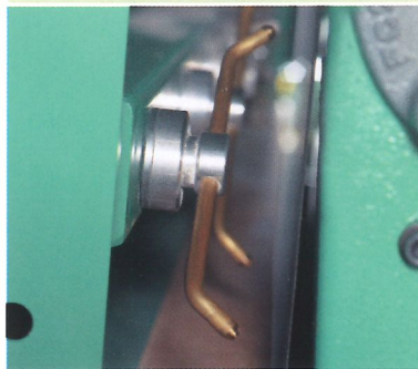
Rotierende Ausblasdüsen zur Bandreinigung
