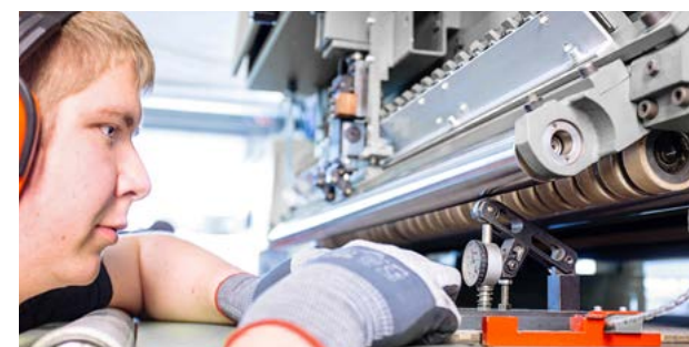
Technicien mécanicien calibrant le système de mesure d'une machine en atelier
