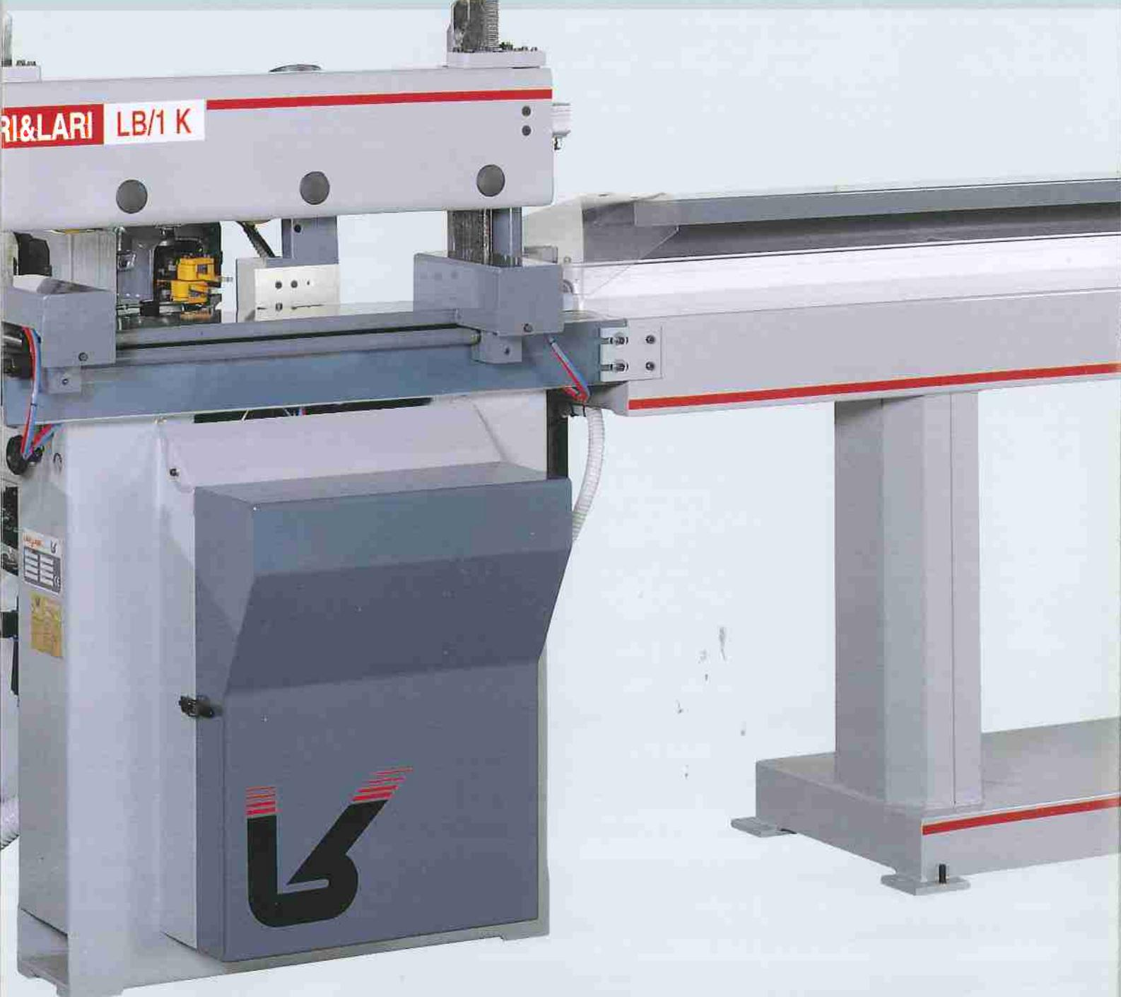
• På basis af standard modellen LB 1 K har vi udviklet en stemmemaskine, som egner sig specielt til det danske marked. Maskinen er i stand til med det rette udstyr f.eks. at stemme en dør-sideramme og bore firkantede huller til sprosser i et og samme gennemløb. Maskinens funktion mindsker håndteringen af emnerne, mindsker fejlmulighederne og er derfor særdeles lønsom.
