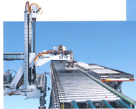
Kommissionsweise Beschickung der Anlage mit ZLE 10
