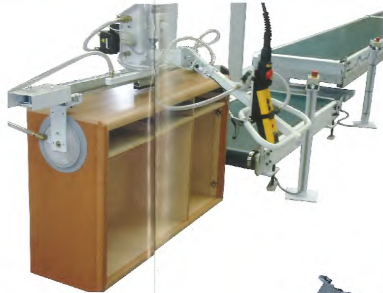
Endmontageband MTB 100 mit Vakuumflöter
