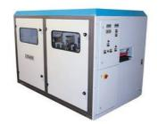
Einfache Walzenaggregate liefern in den seltensten Fällen optimale Schleifergebnisse. Deshalb bietet Löwer mit dem **Multimaster** ein modulares Maschinenkonzept für den Holz- und Zwischenschliff von Profilleisten. Durch den Einsatz von Schleifaggregaten wie Excenter-Discs, Contact-Belt oder Planetenköpfen schafft der MultiMaster ein Höchstmaß an Flexibilität. Und in Verbindung mit dem Bürstschleifsystem Smart-Flex werden bisher unerreichte Schleifergebnisse erzielt.
