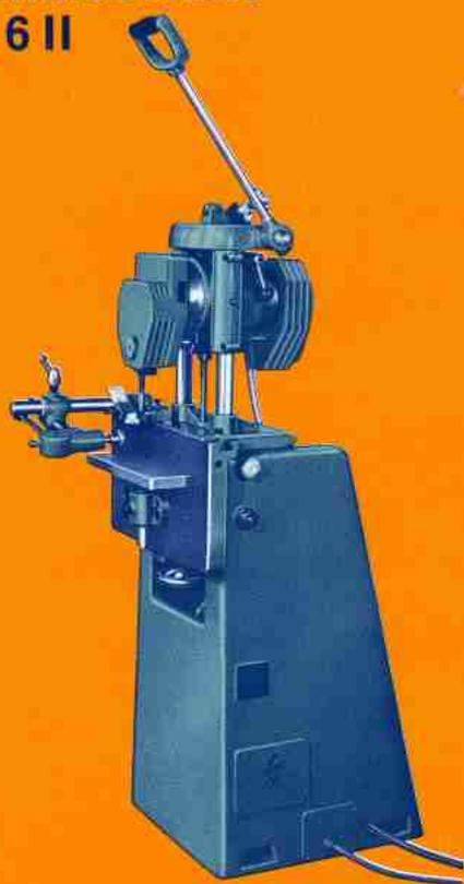
Robuste 1,3-kW-Ständer-Stemmaschine zur schnellen Herstellung rechteckiger Stemmlöcher. Einsatzbereich für Schlitzte bis ca.  $12 \times 50 \times 50$  mm. Vielseitig einsetzbar. (Beispiele: Einlassen von Fitschen-Bändern, Gestellfertigung, Sitzmöbelherstellung, Stemmen von Leiternholmen.) Aggregat schwenkbar für vertikale und horizontale Arbeitsweise. Werkstückauflage neigbar.
