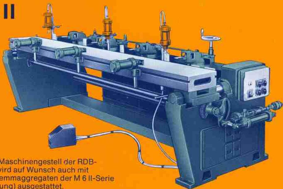
Das robuste Maschinengestell der RDB-Typenreihe wird auf Wunsch auch mit leichteren Stemmaggregaten der M 6 II-Serie (1,3 kW Leistung) ausgestattet.
