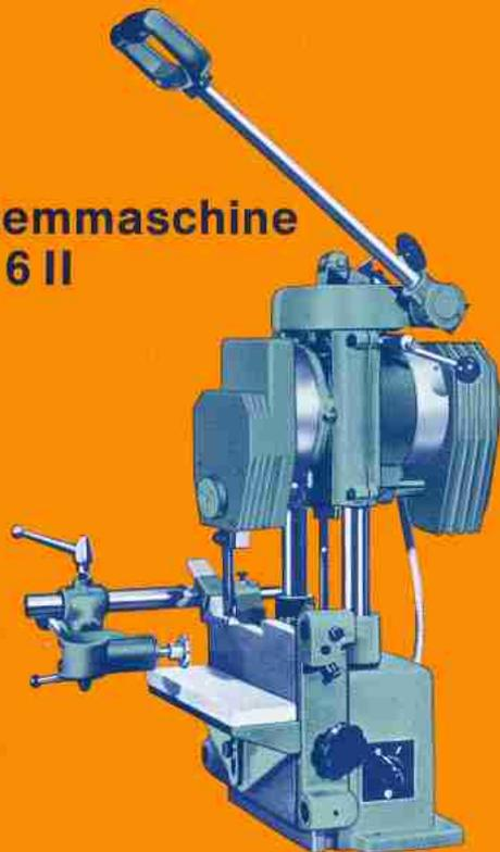
Robuste 1,3-kW-Tischmaschine zur schnellen Herstellung rechteckiger Stemmlöcher. Einsatzbereich für Schlitzte bis ca.  $12 \times 50 \times 50$  mm. Aggregat bis  $30^\circ$  drehbar.
