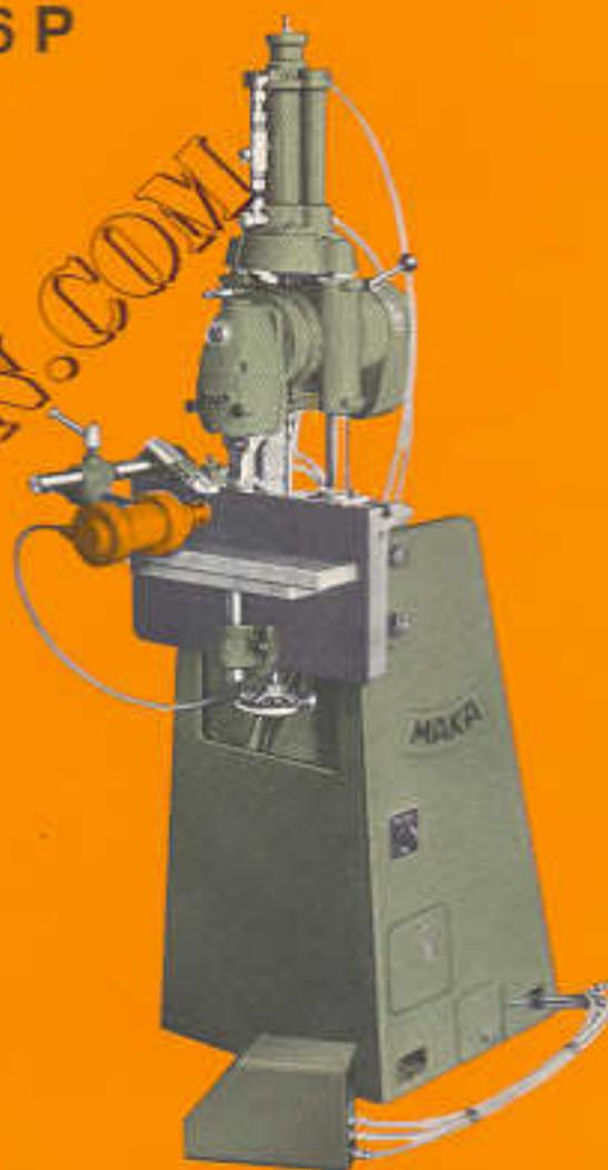
Gleiche Ausführung wie SM 6, jedoch mit pneumatischer Steuerung. Der Arbeitsablauf einschließlich Spannen und Entspannen des Werkstücks erfolgt automatisch und wird durch Impulsgabe über einen Fußschalter ausgelöst. Auf dieser Maschine wird durch die Entlastung des Bedienungsmanns eine wesentlich höhere Produktivität erzielt.
