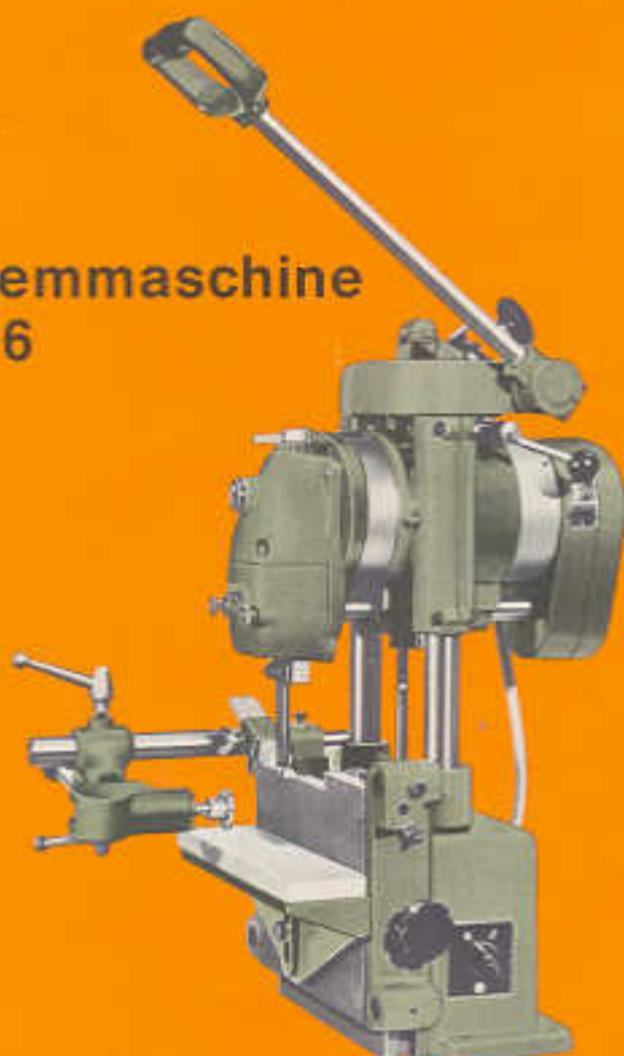
Robuste 1,3-kW-Tischmaschine zur schnellen Herstellung rechteckiger Stemmlöcher. Einsatzbereich für Schlitze bis ca.  $12 \times 50 \times 50$  mm. Aggregat bis  $30^\circ$  drehbar.
