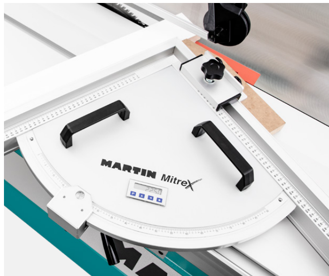
MitreX z cyfrowym wskaźnikiem kątowym
