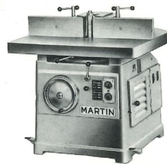
T 21 Tischfräsmaschine 3000 + 4500 + 6000 + 9000 UpM
