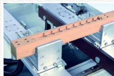
Механические зажимные устройства для обработки заготовок из массива, для линейных и арочных элементов.
