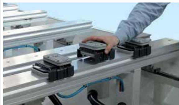
Вакуумная система крепления присосок значительно сокращает время подготовки рабочего стола к работе.
