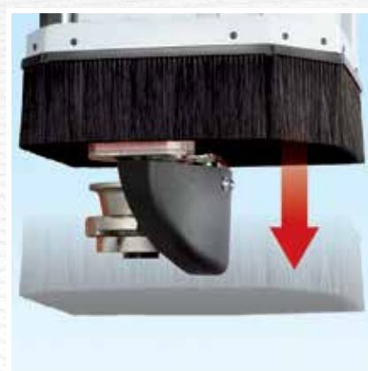
Управляемый ЧПУ аспирационный кожух с регулируемой высотой (стандартно) и установленный на инструменте дефлектор для отвода стружки (опционально) в целях оптимизации работы системы аспирации.
