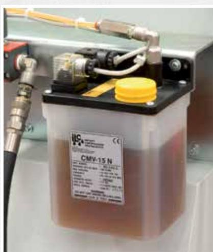
Lubrificazione automatica centralizzata gestita da CN su tutti i movimenti della macchina.
