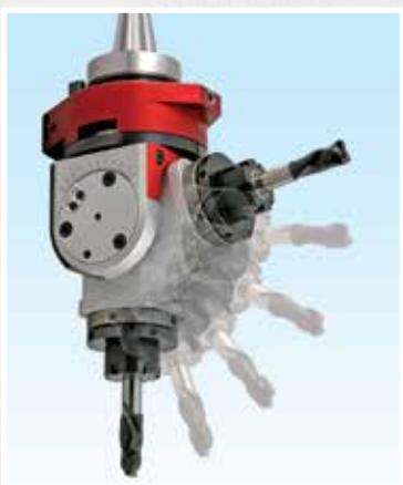
Un'ampio set di testine angolari fisse o inclinabili completano la configurabilità e rendono questo centro di lavoro ideale per la lavorazione di pannelli, porte, finestre, scale e per ogni applicazione speciale.
