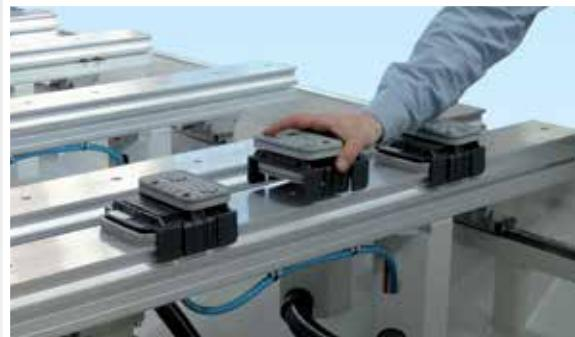
Il sistema di depressione permette il posizionamento rapido dei dispositivi di bloccaggio riducendo notevolmente i tempi per la configurazione del piano di lavoro.
