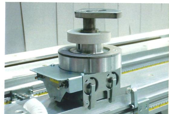
Dispositivi meccanici di bloccaggio per la lavorazione di elementi in massello, lineari e ad arco.
