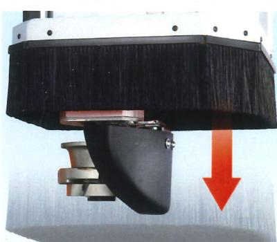
Cuffia di aspirazione con altezza variabile (std) e deflettore di trucioli sull'utensile (opt) gestiti da CN per l'ottimizzazione dell'aspirazione.
