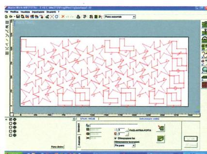
Il software per l'ottimizzazione automatica della disposizione di particolari da ricavare in un unico pannello.
