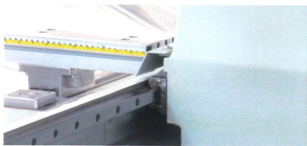
Scorrimenti con guide lineari di alta qualità e precisione. Motorizzazioni Brushless e guide lineari con pattini a ricircolo di sfere di alta qualità e precisione su ogni asse.
