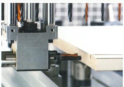
**1** Rotazione asse C per l'impiego di testine angolari fisse o inclinabili.
