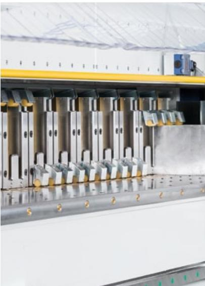
Mehrfachgreifer für höchste Flexibilität bei unterschiedlichsten Bauteilbreiten.
