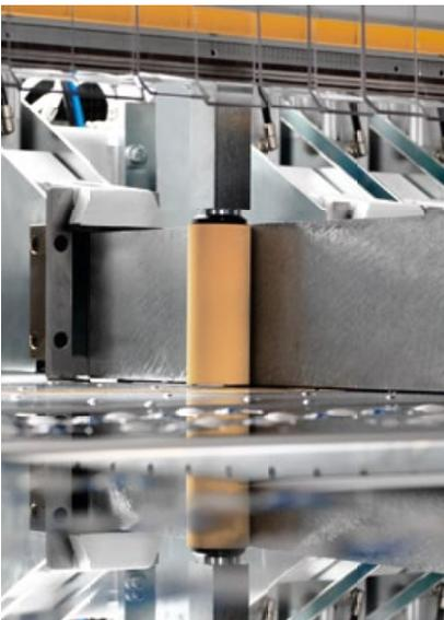
Pneumatische Anpresserrolle im zuführenden Tisch für exakte Winkelschitte auch bei langen Bauteilen.
