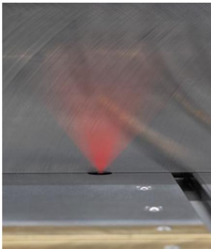
Automatisches Längenmesssystem für Besäumschnitte.
