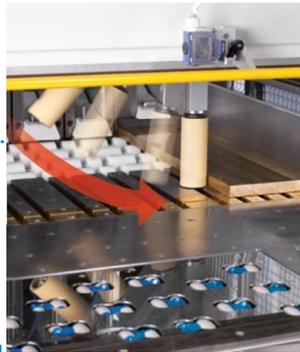
Pneumatisch gesteuerte Anpresseinheit für Streifenschnitte.
