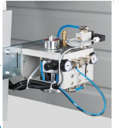
Minimalmengen-Schmiersystem mit ergonomisch angeordneter Bedieneinheit.
