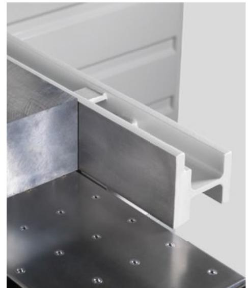
Ergonomischer Luftkissentisch mit langem Winkelanschlag für einfachste Bedienbarkeit und hohe Winkelgenauigkeit an der Schnittlinie.
