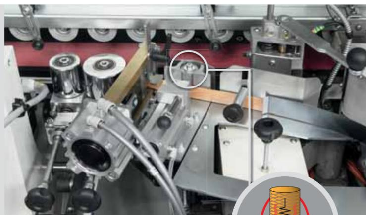
Der Klebstoff wird gleichmäßig, auch bei maximaler Betriebstemperatur, auf Platten mit maximale Arbeitshöhe, dank der Leimauftragswalze mit innerem Widerstand aufgetragen.
