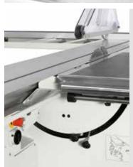
Der Vorritzer mit eigenem Antrieb ist ohne Schlüssel von außen regulierbar und erlaubt schnelle, präzise und spielfreie Positionierungen.
