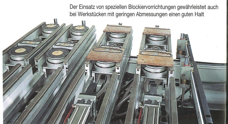
Der Einsatz von Frontandrückern erleichtert die Blockierung und Bearbeitung von kleinen Werkstücken ganz wesentlich
