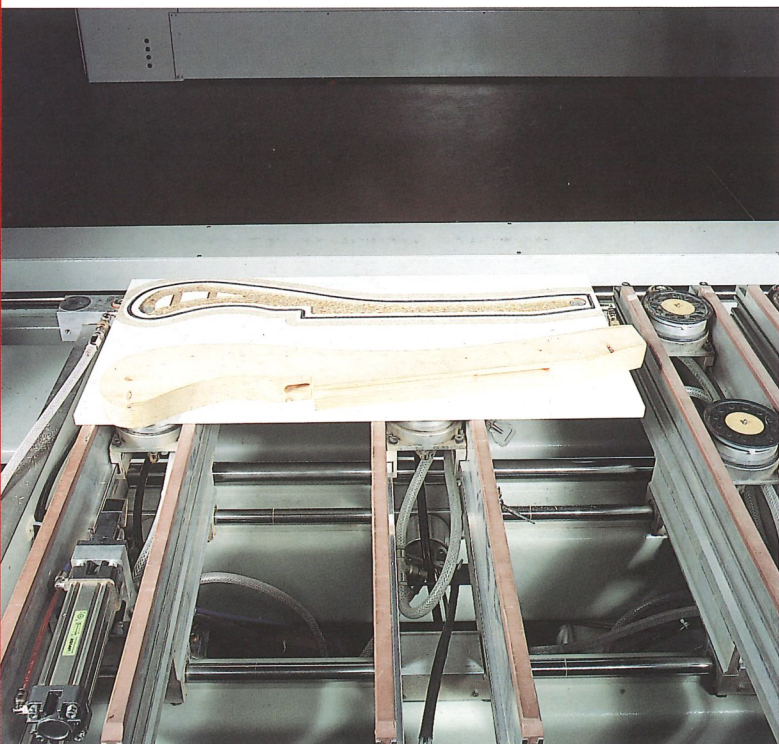
Die Doppelauflagen sind mit doppelter pneumatischer Blockierung ausgerüstet
