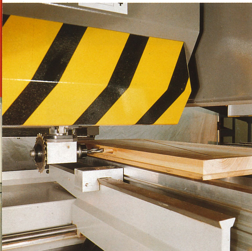
360° Horizontal- winkelgetriebe mit Aufnahme für Nutsäge und Schaftfräser.
