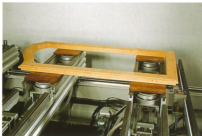
▲ Der Einsatz von Spezialvorrichtungen gewährleistet auch die Fixierung von Werkstücken mit außergewöhnlichen Abmessungen
