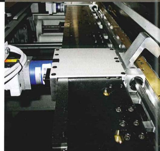
Druckbrücken mit unabhängiger Bewegung und Werkstückaufspannung mit NC-Steuerung: in jeder Situation höchste Schnelligkeit beim Aufspannen der Platte, zusammen mit der Garantie, dass sie während der Bearbeitung hält, und das Ganze ohne Gefahren für die Oberfläche Ihrer Platte.
