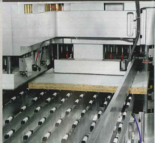
Die neuen Platten-Spannzangen mit einer neuen Geometrie und voneinander unabhängigen Bewegungen bieten die Möglichkeit, auch an Stellen innerhalb der Zange Bohrungen vorzunehmen, um die Neupositionierung der Spannzangen zu optimieren und die Zykluszeiten zu senken.
