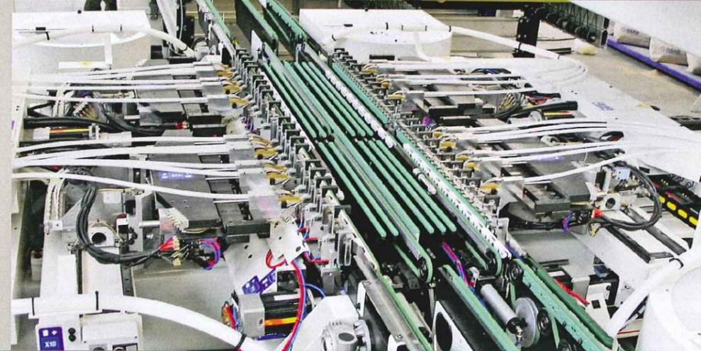
Die Plattenförderung passt sich ständig an die Abmessungen und das Gewicht der Werkstücke an; dies geschieht durch einen Inverter, der Geschwindigkeiten bis zu 120 m/min steuert.
