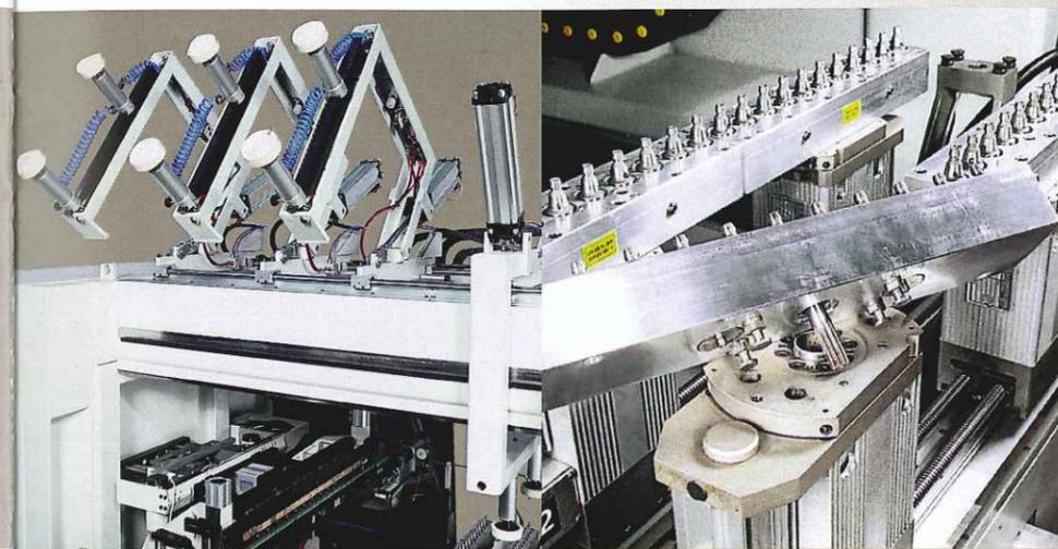
Durch ein Druckluftsystem, das mit Tasten aktiviert wird, die sich in ergonomischer Lage befinden, werden die Druckbrücken gehoben, bis sie sich im oberen Teil des Trägers positionieren. Dadurch bleibt die Maschine für die verschiedenen Tätigkeiten zum Rüsten völlig offen.
