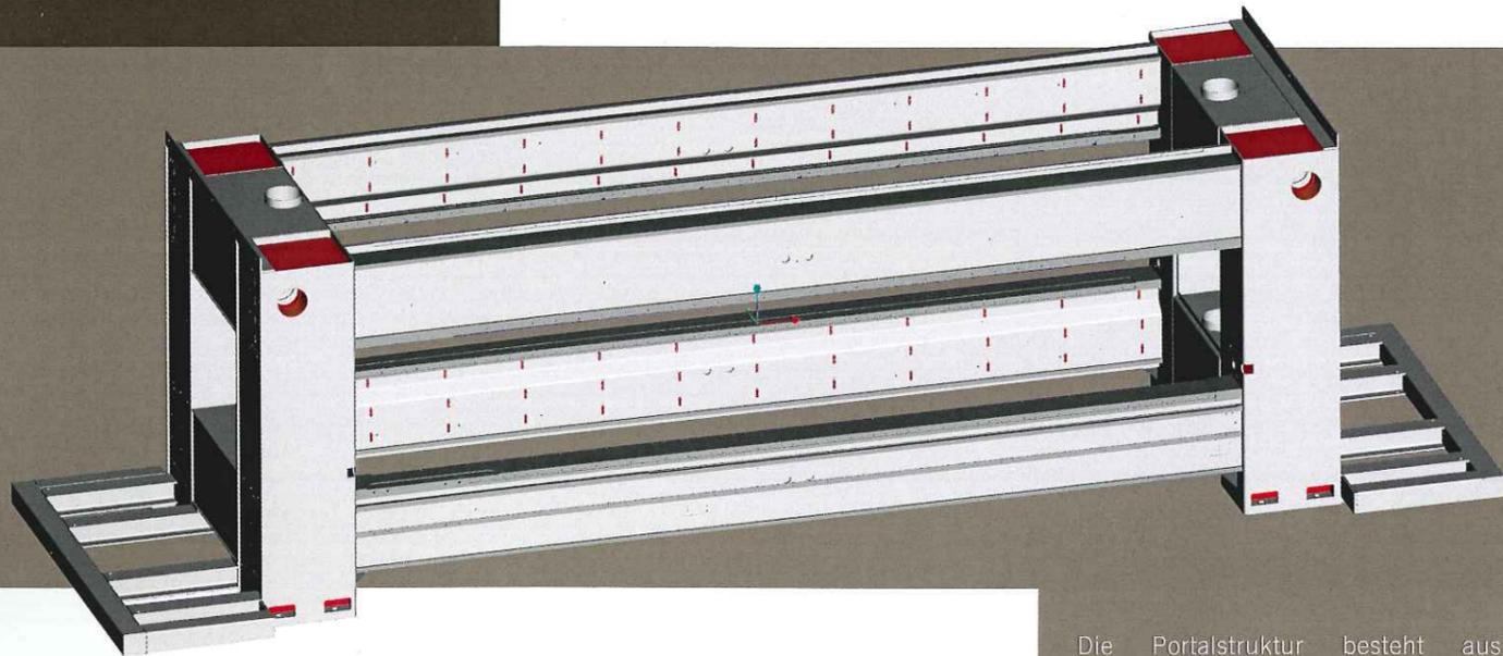
Die Portalstruktur besteht aus einem robusten Rahmen aus elektrogeschweißtem Stahl mit Versteifungsrippen. Dies gewährleistet, dass der Rahmen völlig schwingungsfrei ist und sich auch bei starker dynamischer Belastung wie bei der gleichzeitigen Positionierung aller Arbeitsaggregate, bei der Verschiebungsgeschwindigkeiten bis zu 90 m/min erreicht werden können, nicht verformt.
