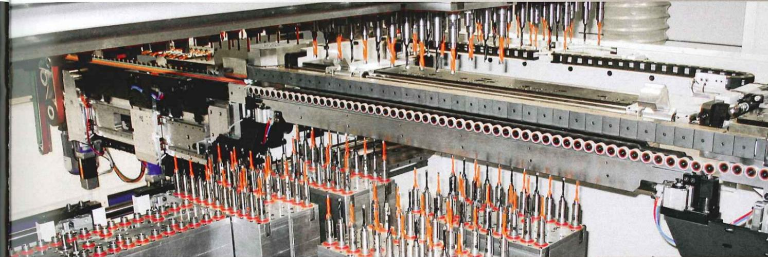
► Mehr als 600 Bohrer mit unabhängiger Anwahl zur Bearbeitung der sechs Seiten der Platte mit einer einzigen Maschine.
