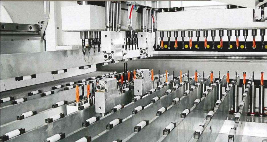
Aus einem einzigen Guss aus Alu-Legierung hergestellt und aus dem Vollen bearbeiteter Bohrkopf für hohe Bohrpräzision ( $\pm 0,1\text{mm}$ ); bis zu 66 unabhängige Spindeln: 48 vertikale und 18 horizontale. Drehzahl von 6000 U/min mit den neuen Spindeln aus gehärtetem Stahl und integrierten patentierten Keramiklagern.
