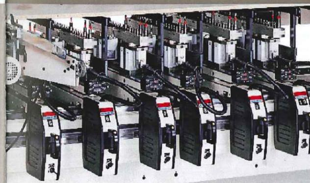
Beim Übergang von einem Programm zum nächsten sendet die Steuereinheit die Maße, in denen sich das alte und das neue Programm unterscheiden, an alle Displays. Der Bediener muss nur noch jedes Aggregat in die Richtung verschieben, die am Display gezeigt wird, bis das angezeigte Maß auf Null steht.
