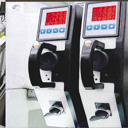
Das Positioniermaß der Bohraggregate wird dem Bediener auf digitalen Displays angezeigt, wodurch das Einstellen rascher und präziser vonstatten geht.
