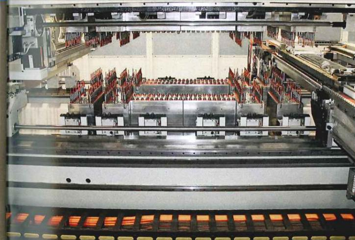
Die flexible Lösung zur Herstellung Ihrer Werkstücke: die automatische und unabhängige Drehung jedes Bohrkopfs, auch innerhalb eines Arbeitsprogramms, um auch bei den komplexesten Bohrplänen starke Leistungen zu erbringen.
