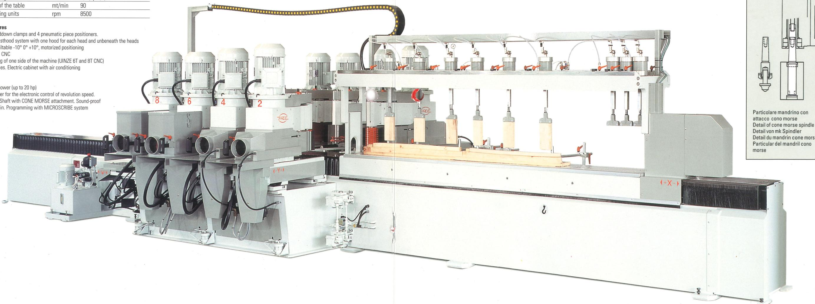
Apertura di una lato della macchina (nei modelli UINZE 6T e 8T CNC) per un facile e completo accesso al cambio degli utensili: un dispositivo idraulico con livellamento automatico attiva in modo rapido e preciso il movimento di apertura e chiusura. Sistema di oscillazione della carta a levigare completamente meccanico. Pressori pneumatici con stelo esagonale e sistema antirotazione.
