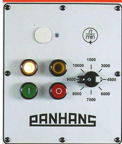
Frequenzregelung für 8 Spindeldrehzahlen. Sonderzubehör
