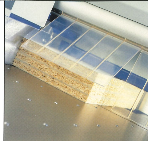
Paketschnitte mit CNC gesteuerter Druckbalkenpositionierung und Seitendruckvorpositionierung
