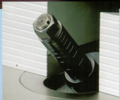
Die Spindel mit 30 mm Durchmesser
