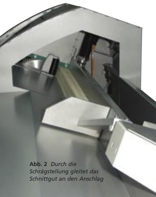
Abb. 2 Durch die Schrägstellung gleitet das Schnittgut an den Anschlag
