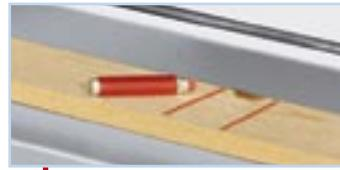
Abb. 11 Markierte Fehler werden ausgekappt (Option)
