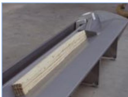
**Abb. 4 + 5** Serienmäßig hochklappbarer Schieber ermöglicht Längenvermessung und Kreidestrickerkennung – ideal auch zum Kappen von Paketen
