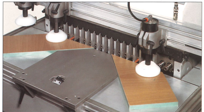
Foratrice monotesta elettronica a 21 mandrini Perceuse électronique monotête avec groupe de perçage à 21 broches Electronic single-headed boring machine with a 21-spindle unit Elektronische Einkopf-Bohrmaschine mit 21 Spindeln Perforadora electrónica monocabezal con 21 mandriles Furadeira electronica monocabeça com 21 mandris
