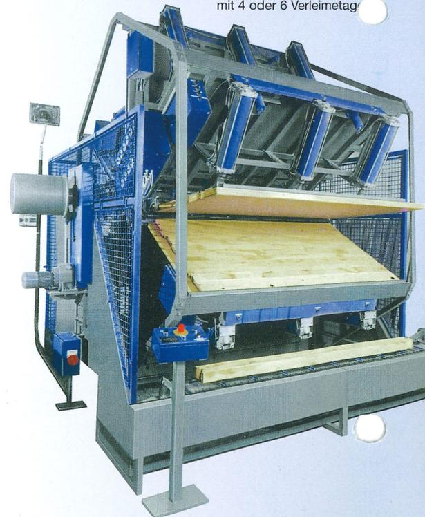
**Elektrisch beheizte Pneumatik-Etagen-Verleimanlage**
