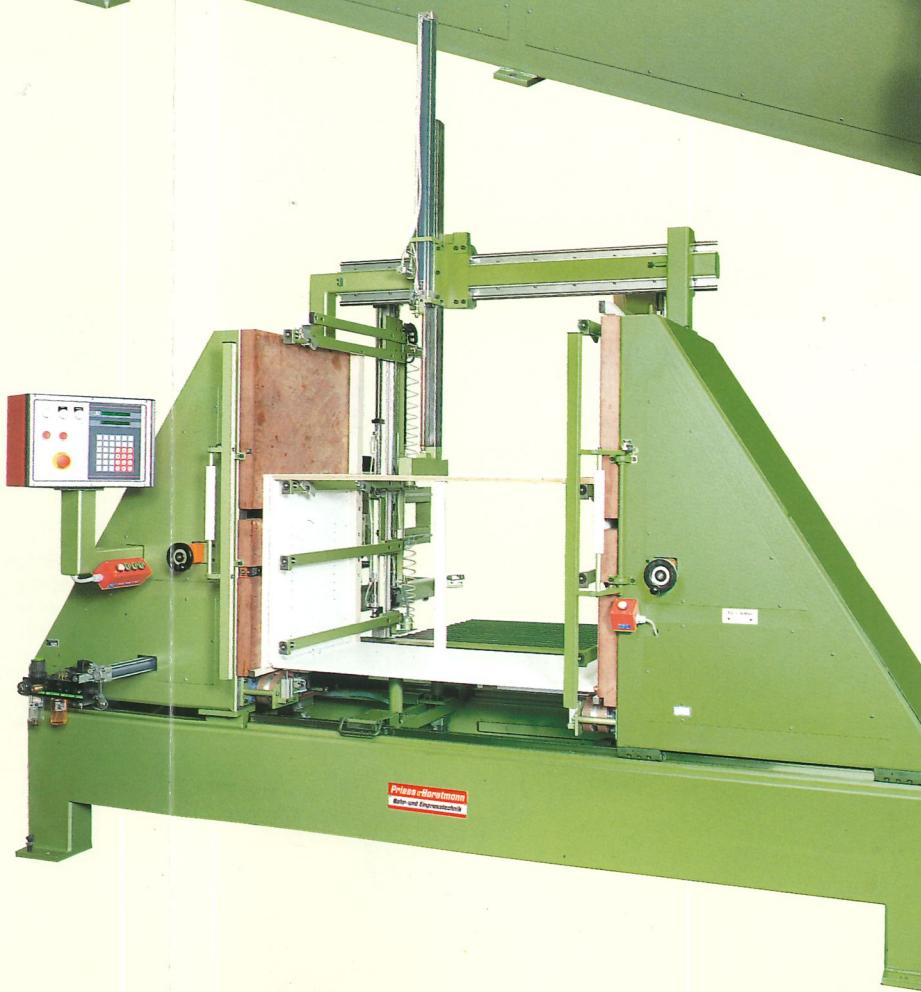
Die elektronisch gesteuerte Korpuspresse KP - CNC kann entweder ON-Line mit der Bohrmaschine verbunden sein oder völlig unabhängig davon arbeiten. Ein Vorstecken außerhalb der Presse ist dabei nicht erforderlich. Die Teile laufen entweder automatisch in die Korpuspresse ein oder werden manuell in automatisch vorpositionierte Taschen oder Auflagearme gelegt und fixiert.
