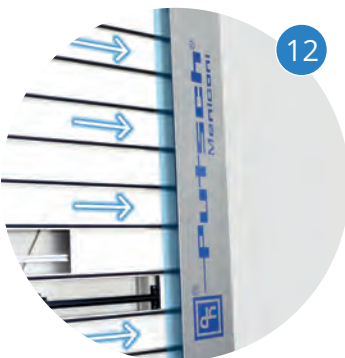
Convogliatore polvere lato destra per tagli orizzontali TRK Buse pour captation poussière dans les coupes horizontales TRK
