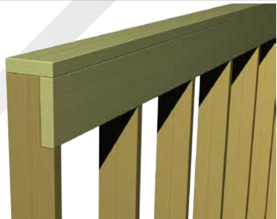
Stiele mit Aussparung in einer Wand mit tragendem Sturzbalken
