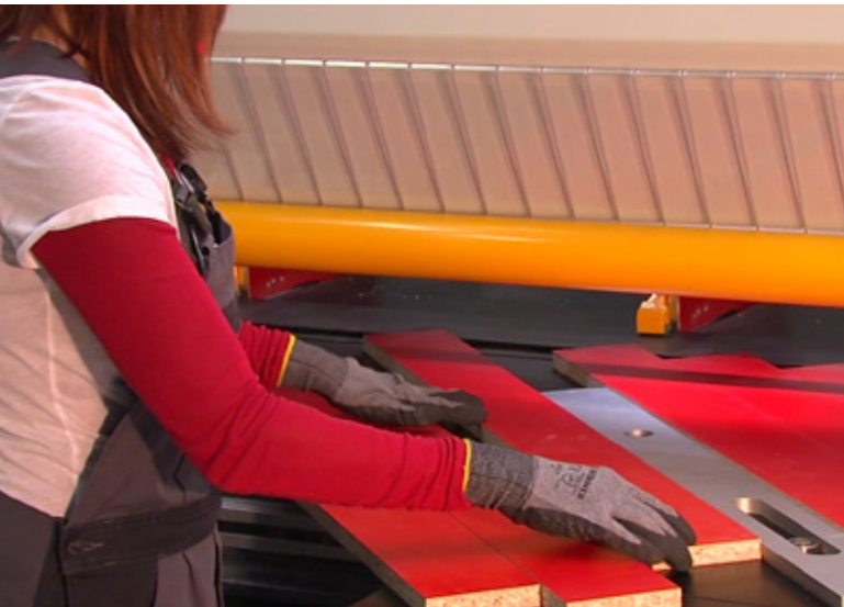
Shifterschnitte: Winkelschnitteinrichtung in Kombination mit Gehrungsschnitt
