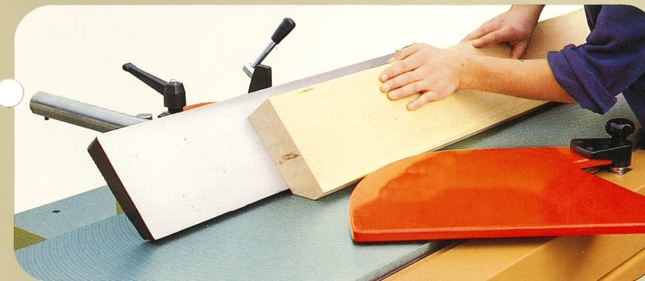
Guide inclinable. Schrägstellbarer Abrichtanschlag.
