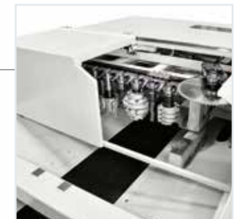
Ferngesteuertes Werkzeugwechsler CADDY 35 , integriert in der Maschine.
