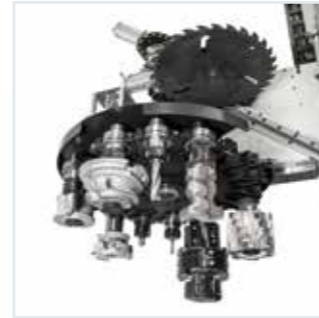
VELOCE 16 On-board-Werkzeugwechsler , das sich auf dem Arbeitsaggregat befindet, um Werkzeugwechsel in maskierter Zeit durchzuführen. Ein „Pick-up“ für Sägeblätter mit großem Durchmesser ist verfügbar.
