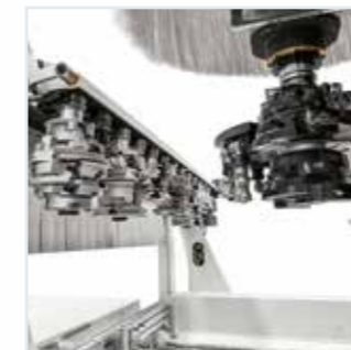
FAST 16 On-board-Werkzeugwechsler mit linearer Entwicklung, positioniert an Bord des mobilen Portals, um die Werkzeugwechselzeiten zu minimieren. Ein „Pick-up“ für Sägeblätter mit großem Durchmesser ist verfügbar.
