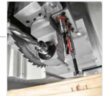
BRC-S Arbeitsaggregat zum Schneiden, Fräsen und Bohren, sowohl vertikal als auch horizontal
