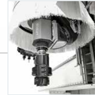
KPX 5-Achsen-Arbeitsaggregat mit 17kW Elektroschmelze
