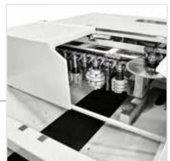
*Ferngesteuertes Werkzeugwechsler CADDY 35, integriert in der Maschine*
