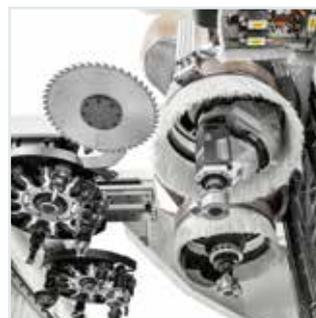
*Arbeitsaggregat mit zwei unabhängigen Aggregate, die jeweils mit einem on-board Werkzeugwechsler ausgestattet sind.*
