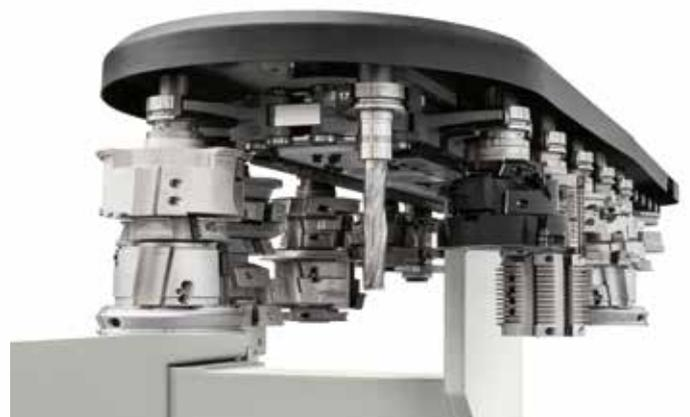
Dank des hinteren TRC-Werkzeugwechslers mit 32 Positionen steht dem Bediener stets eine große Auswahl an Werkzeugen zur Verfügung.
