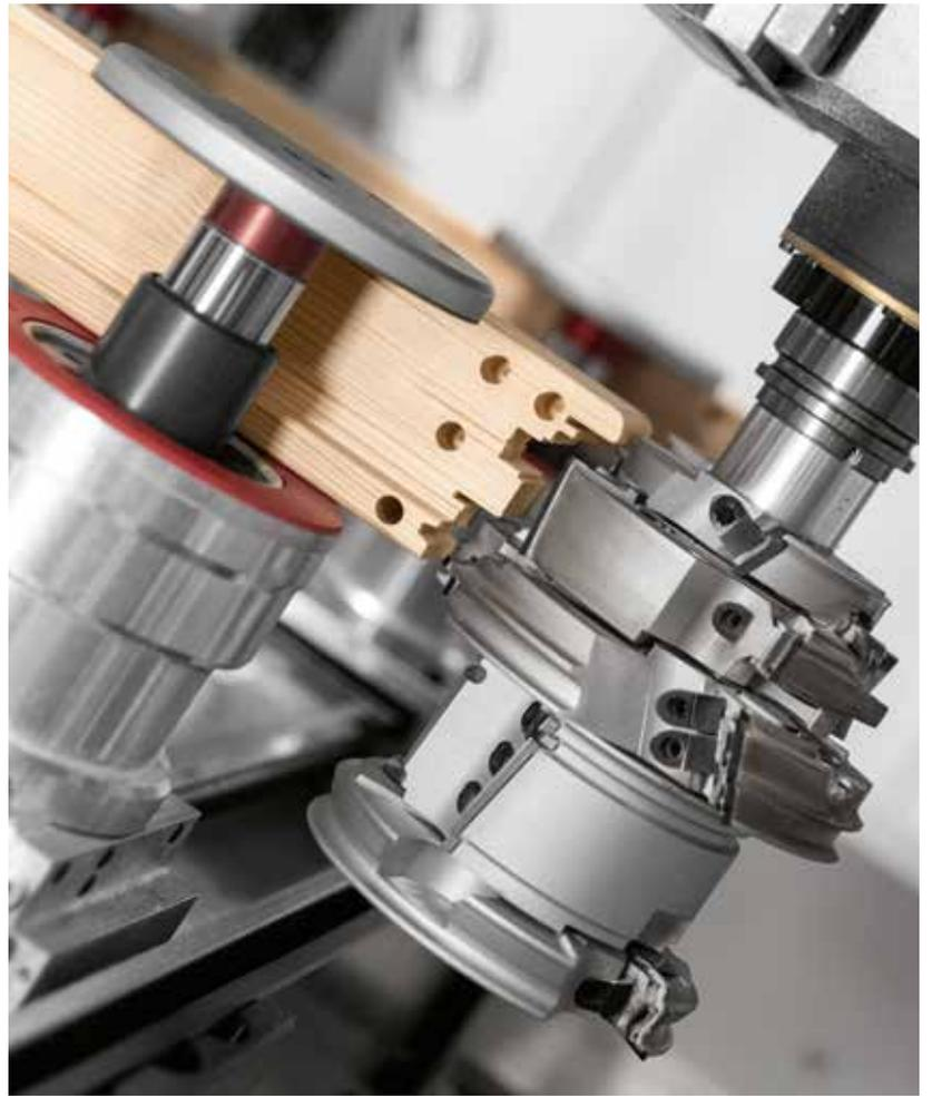
**MULTIGRIP (H83) und PROFIGRIP (H145)** spannen mit Doppelprofil-Werkzeugen Elemente unterschiedlicher Dicke, von 45 bis 105 mm bzw. von 60 bis 120 mm, ohne manuelles set-up zu benötigen.
