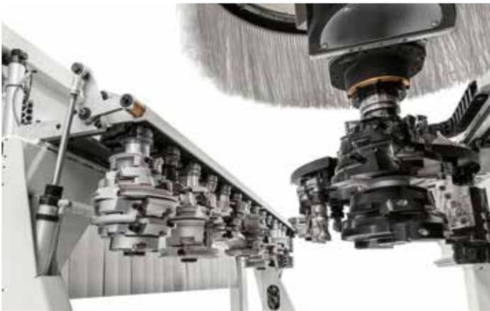
Kein stillstand während des Werkzeugwechsels durch das Werkzeugwechsler **FAST** mit 16 Plätzen.
