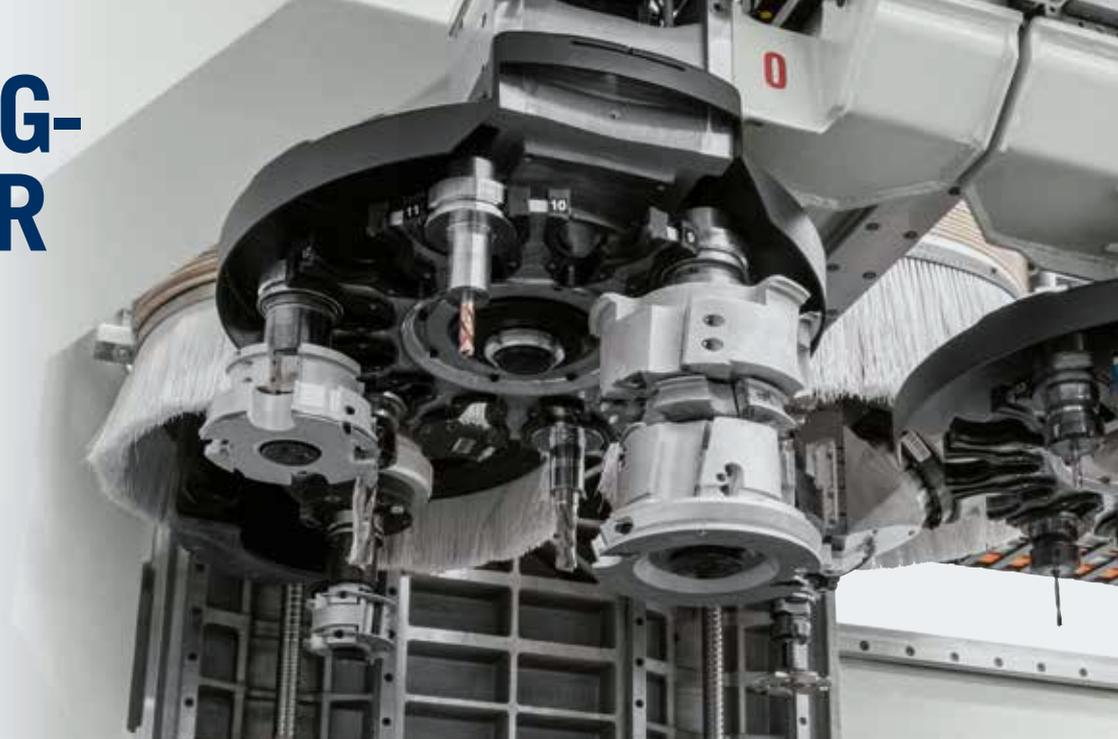
**AUF NULL REDUZIERTE WERKZEUGWECHSELZEITEN:** exklusive Konfiguration mit doppelter Elektrospindel und Doppel-Werkzeugwechsler. Während der eine Kopf das Werkstück bearbeitet, bereitet der zweite das Werkzeug für die nächste Bearbeitung vor.
