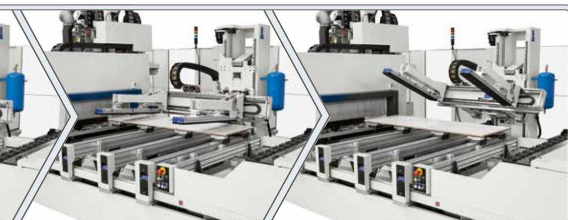
Der flexible Arm von Cargo ermöglicht das kontinuierliche Be- und Entladen von Werkstücken in verdeckter Zeit, während die Maschine im gegenüberliegenden Bereich die Bearbeitung durchführt.
