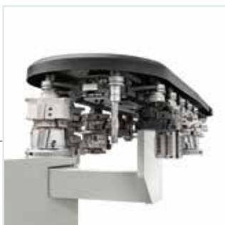
*Das Ketten-Werkzeugwechsler TRC 32, das sich an der Rückseite des mobilen Portals befindet, ermöglicht den Werkzeugwechsel an beiden Arbeitsaggregate*
