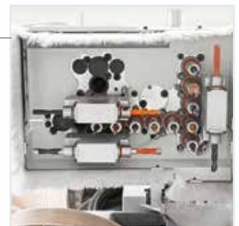
*Leistungsstarke Bohraggregat mit RO.AX. (Rotoaxial Spindle Technology) Spindeln mit hohen Drehzahlen, bis zu 8000 U/min.*
