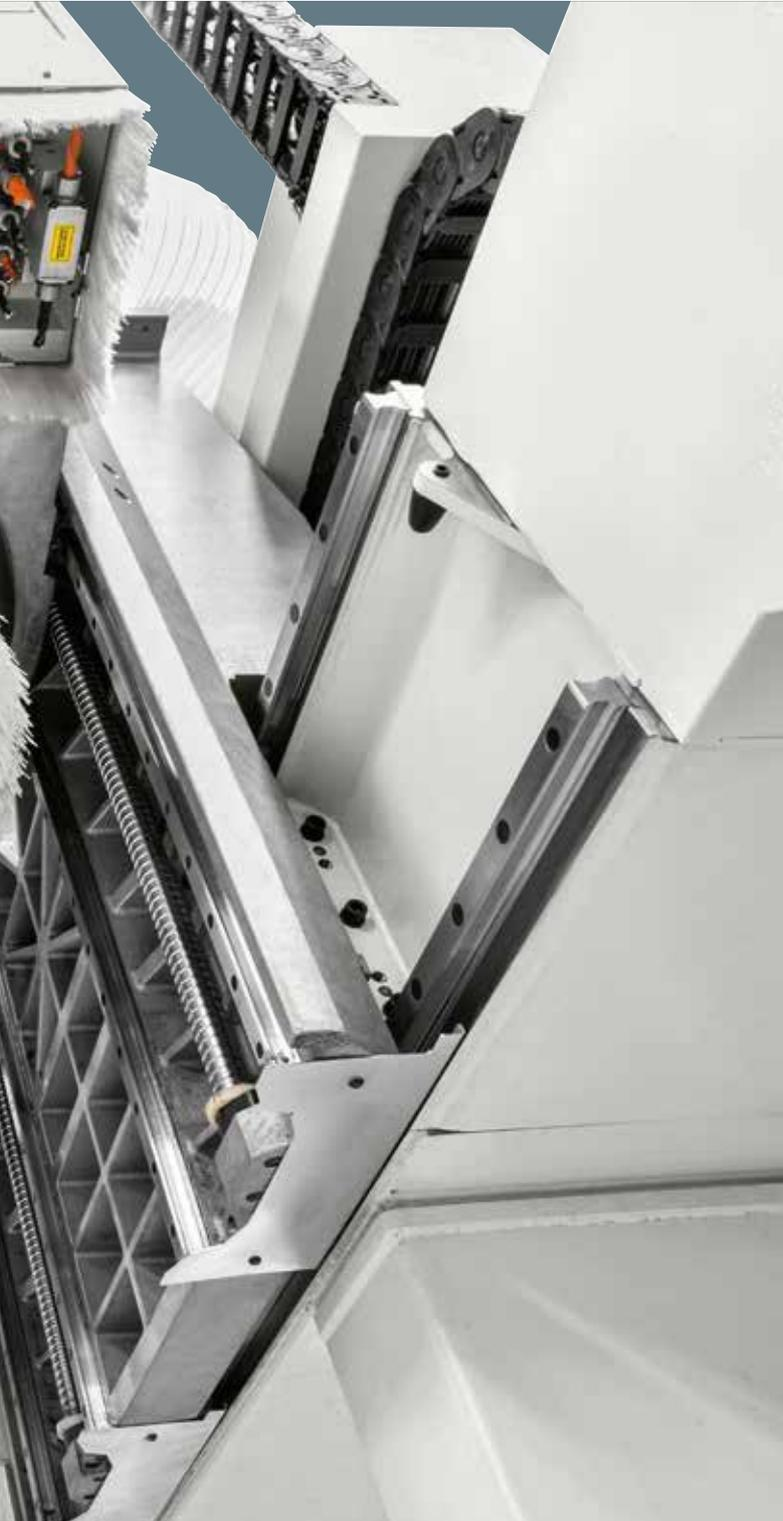
**1** Der „Pick-up“ für Sägeblätter, der sich oberhalb des on-board-Werkzeugwechslers befindet, ermöglicht es, zusätzlich zu den anderen Werkzeugen ein Sägeblatt mit großem Durchmesser (bis zu 400 mm) zu installieren. Auf diese Weise wird der Platzbedarf des Werkzeugwechslers durch seine Größe nicht eingeschränkt.
