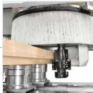
*Koaxiales und integriertes Förderband für maximale Reinigung bei schweren Abtragungen.*
