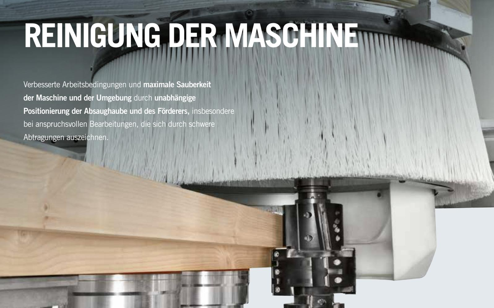
**Keine Probleme mit Staub oder Spänen** mit dem Transportband mit Absaughaube und Spänewagen.
