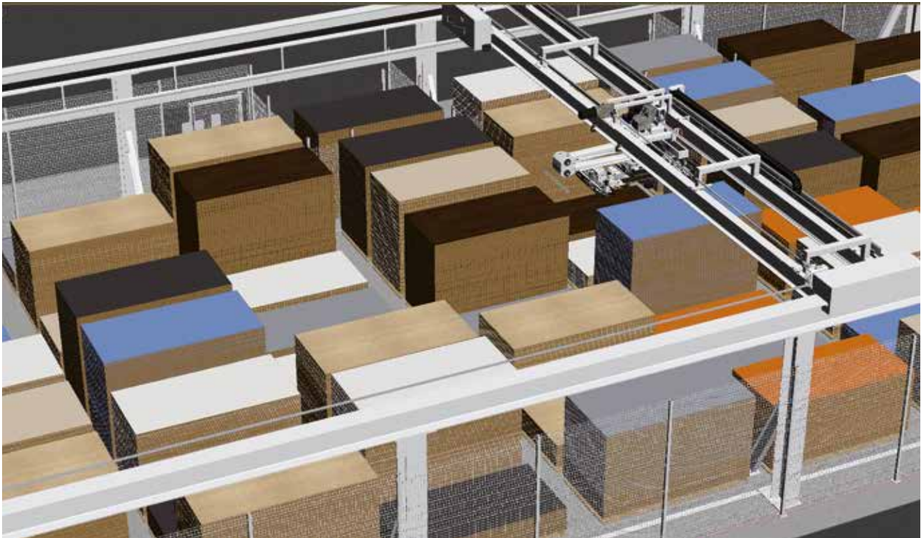
Grâce à la structure en acier, les mouvements se font sans vibrations même dans les magasins de grandes dimensions
