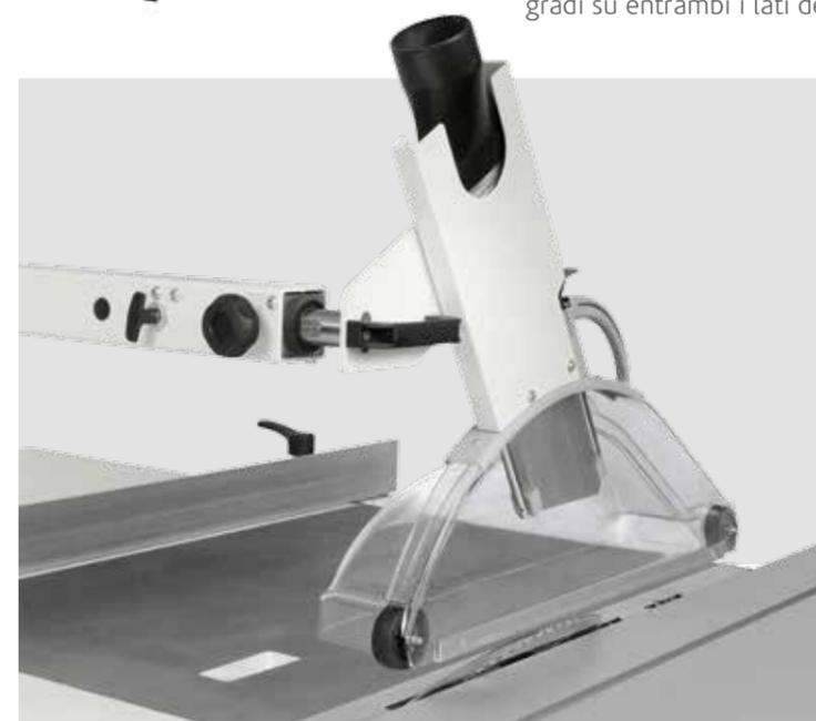
Protezione alla lama di tipo sospeso a due posizioni per una lavorazione alla sega in totale sicurezza.
