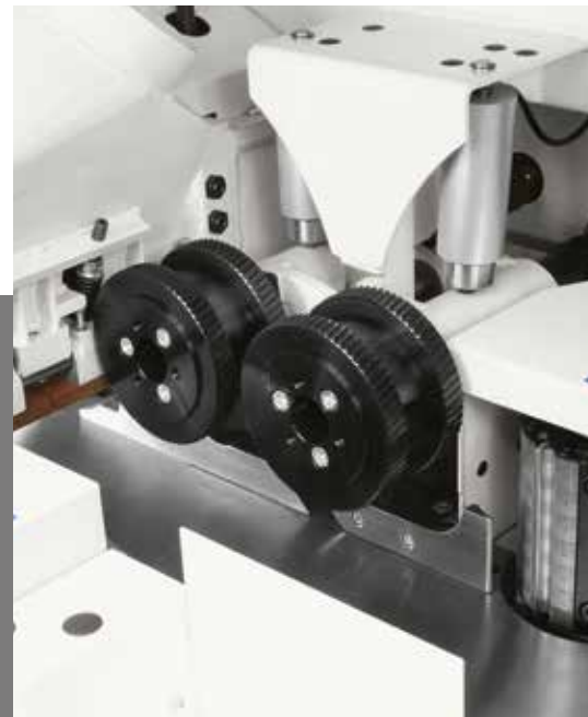
Ausrüstung von zusätzlichen Flanschvorschubrollen vor linker Vertikalspindel
