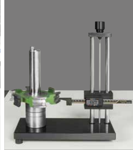
"Preset 25" Vorrichtung zur Massaufnahme des Werkzeugdurchmessers Präzision und bequeme Anwendung.
