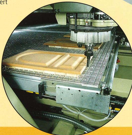
Nach der Aufnahme ist die gesamte Vorrichtung unter dem Arbeitstisch versenkbar, um Bearbeitungen mit jedem Werkzeug zu ermöglichen.
