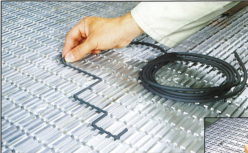
Über **Gummidichtungen** erfolgt die Befestigung direkt am Tisch, wenn nur der obere Teil des Werkstückes bearbeitet werden soll.
