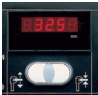
Posizionamento motorizzato del piano tappeto, con visualizzatore digitale dello spessore di lavoro (standard).
