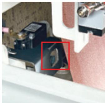
Comando elettronico per la traslazione dei nastri, con fotocellula a soppressione di sfondo (standard).
