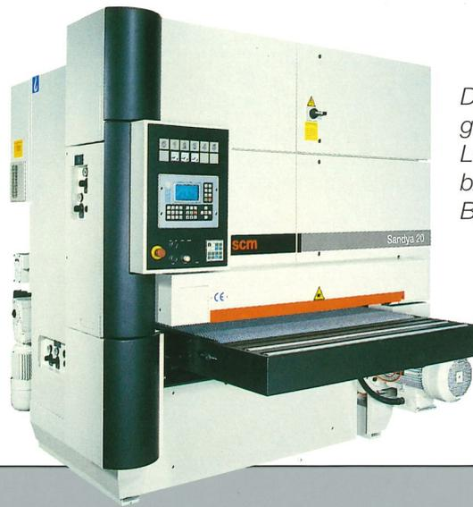
*Der Vorschliff in Querrichtung garantiert, in Kombination mit dem Längsfeinschliff, auch auf furnierten bzw. lackierten Platten hohe Bearbeitungsqualität.*
