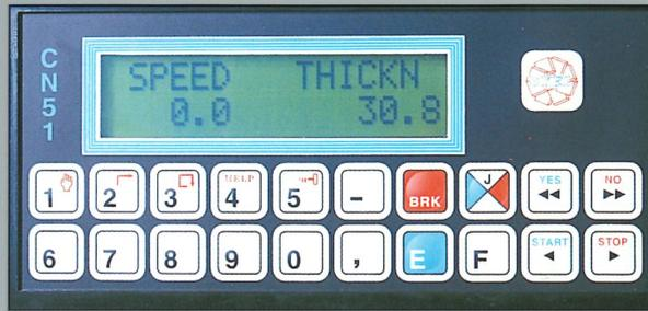
Steuerung mit 100 Programmen: Arbeitshöhe, Vorschubgeschwindigkeit, pneumatisches Zu- und Abschalten oder zeitgesteuerter Einsatz der Aggregate (Walzen oder Schleifschuhe). Bei der Ausführung 100S werden sämtliche Funktionen des Gliederschleifschuhs gesteuert.
