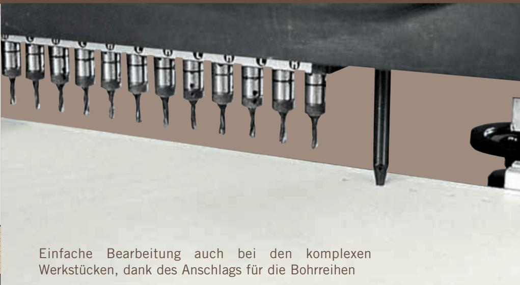
Einfache Bearbeitung auch bei den komplexen Werkstücken, dank des Anschlags für die Bohrreihen
