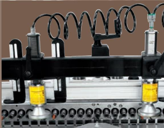
Perfekte Ausrichtung der Fugen dank der Endanschläge, über Millimeterskala einstellbar, und der Druckzylinder für Werkstückspannung
