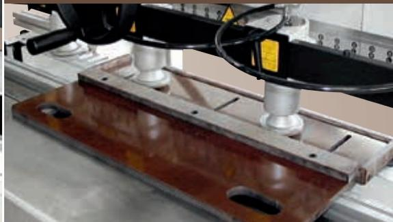
Vorrichtung für die Bearbeitung schmaler Werkstücke (Option)
