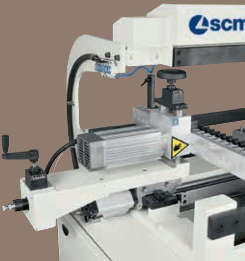
⦿ Öldynamische Bremse auf allen Bohrköpfe für schnellere Bohrungen (Option)
