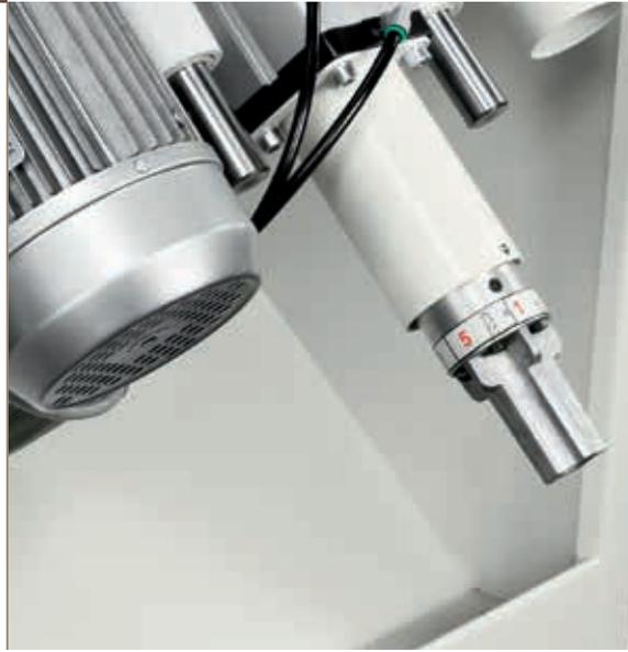
Butée à revolver à 5 positions
