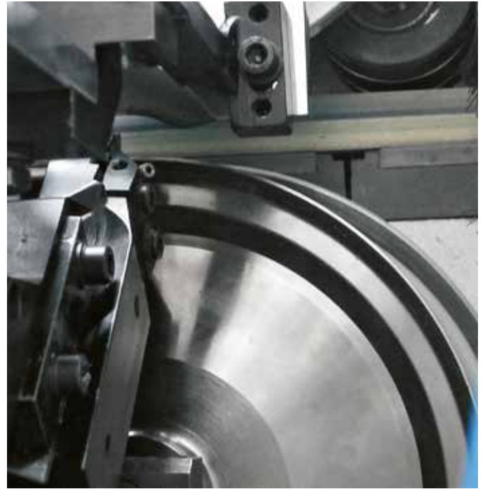
Das "Twin Feeler" Kopiersystem ermöglicht eine konstant hohe Bearbeitungsqualität auch bei hohen Vorschubgeschwindigkeiten (opt.)
