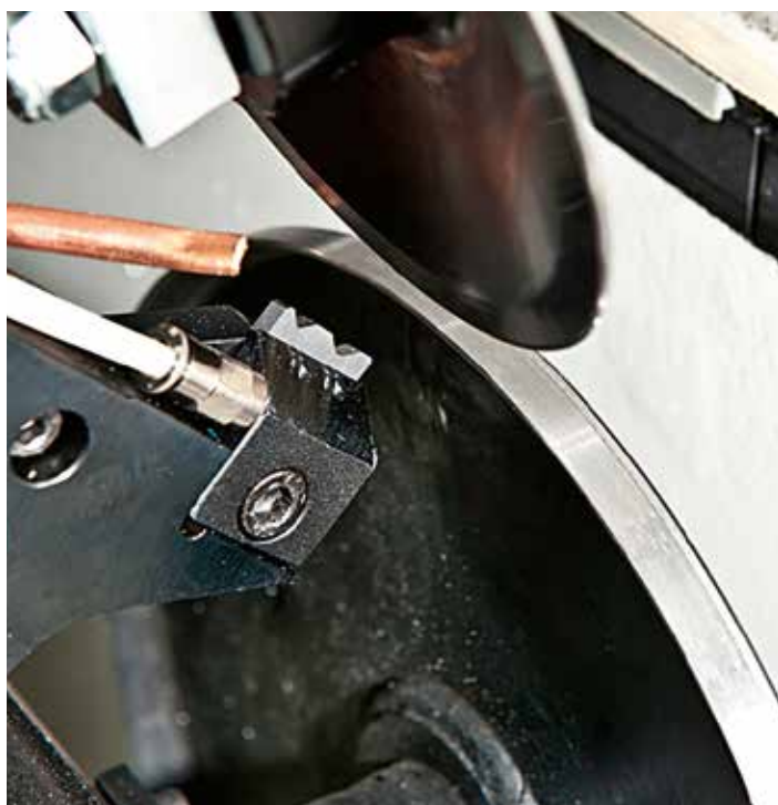
Version für die automatische Bearbeitung von zwei Profilen. Mikroeinstellungen mit NC Achsen.
