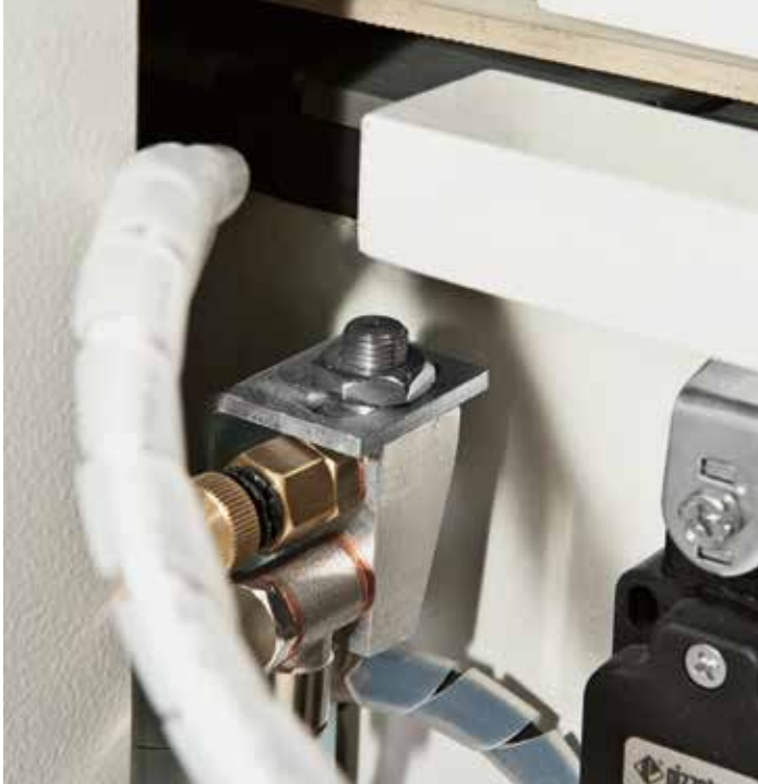
Trennmittelspray um das aneinander Haften von verleimten Werkstücken zu vermeiden.
