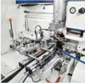
Präzise Stufenlose Einstellung der Leimfuge.
