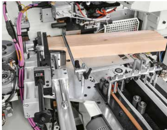
Schneller Einsatz von Massivholzkanten bis 22mm, auch mit 2 oder 6-fach Magazin.
