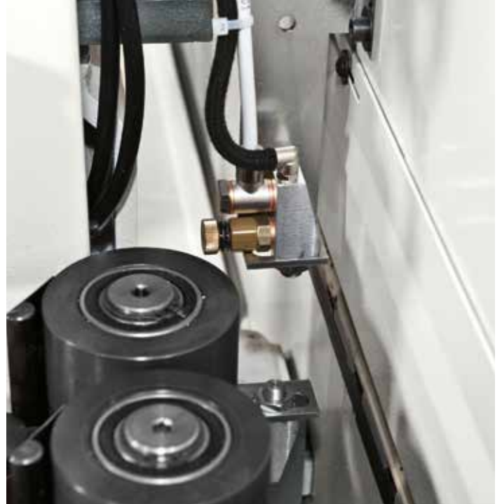
Kühlspray zur Reduzierung der Leimtemperatur, um die Werkzeuge für die nachfolgende Bearbeitung sauber zu halten.
