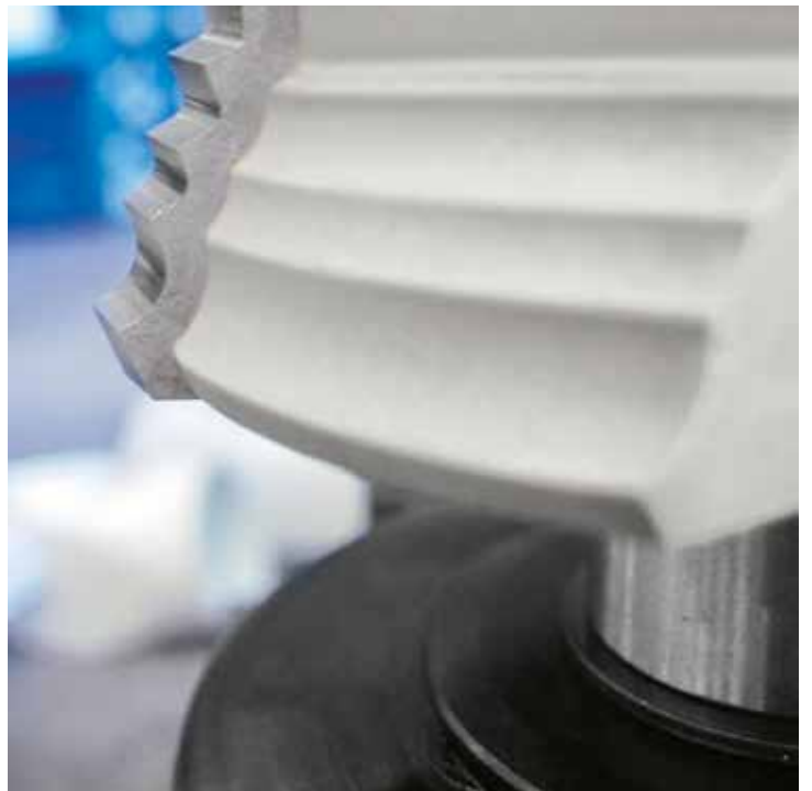
Bearbeitung von 3 Radien mit automatischer Einstellung.
