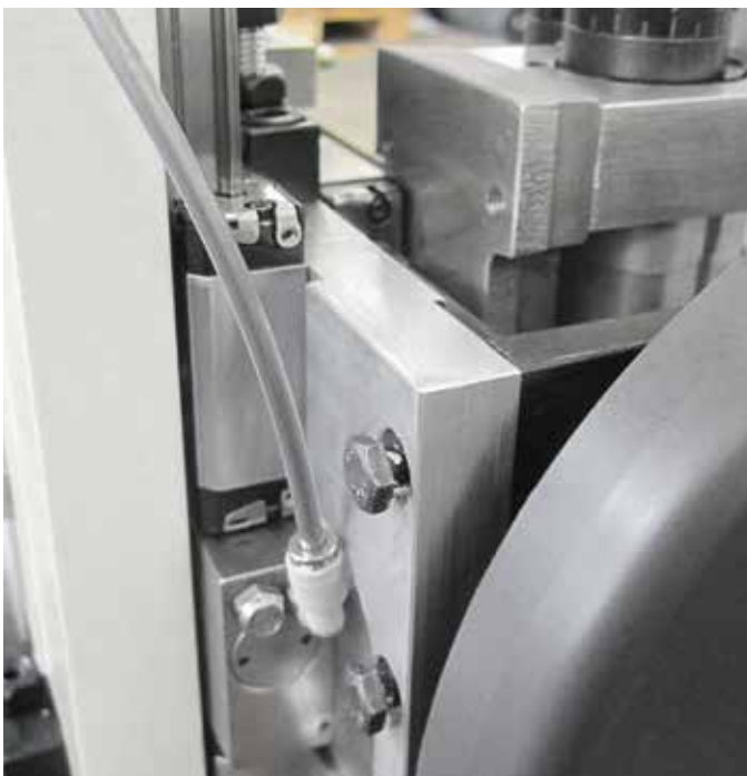
Die "Nesting Lock" Einrichtung für die Bearbeitung von vorgebohrten Werkstücken. (opt.)
