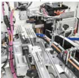
Flexibel Kantenmagazine für bis zu 6 Kanten mit automatischem Einwechseln
