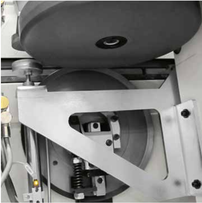
Das zusätzliche Kopiersystem mit großem Durchmesser für die Bearbeitung von dünnen Werkstücken (opt.)
