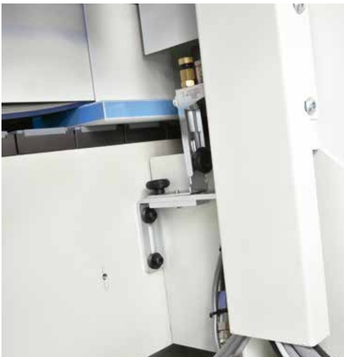
Gleitspray für die Verarbeitung von Hochglanz- und Folienkanten.
