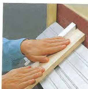
Der Winkelanschlag aus dem Zubehör ist beidseitig um 45 Grad schwenkbar.
