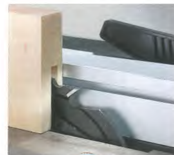
Die ts 2500ci mit angebautem Schlitzfräser. (Die SUVA-Absaugvorrichtung ist für alle verdeckten Schnitte erforderlich)
