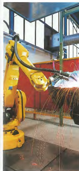
Die Blechbearbeitung wird von Schweißrobotern abgeschlossen. Absolute Wiederholgenauigkeit ist deren besondere Stärke.
