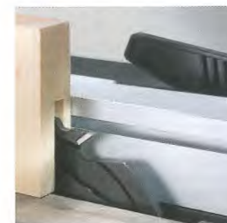
ts 4010ci mit montiertem Schlitzfräser. (Die SUVA-Absaugvorrichtung ist für alle verdeckten Schnitte erforderlich)
