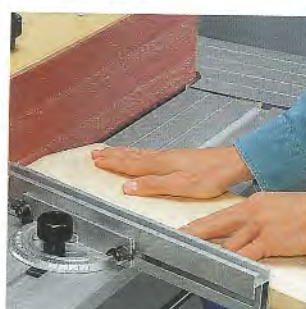
Der Winkelanschlag aus dem Zubehör ist beidseitig um 45 Grad schwenkbar.
