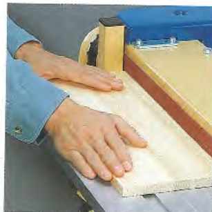
Die stufenlos verstellbaren Tische erlauben gleichmäßige Schleife an Kanten.
