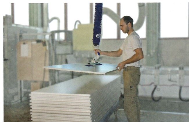
Vakuum-Schlauchheber JumboFlex bei der Handhabung von leichten, beschichteten Holzplatten bis 35 kg
