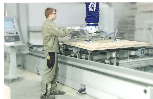
Vakuum-Schlauchheber JumboErgo bei der Beladung eines CNC-Bearbeitungszentrums
