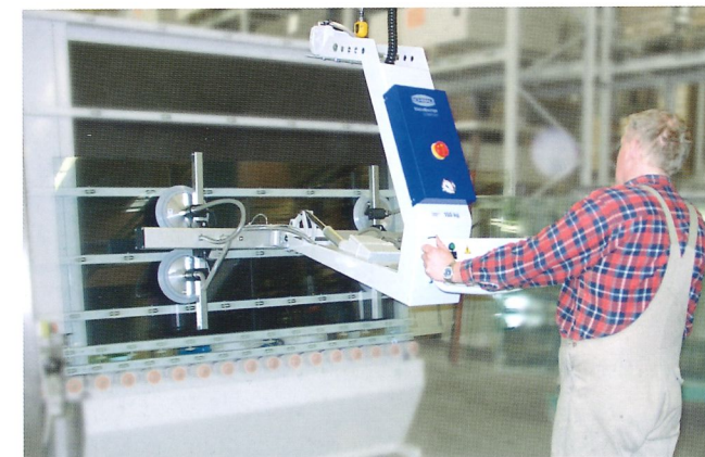
Vakuum-Hebegerät VacuMaster Comfort beim Wenden einer Glasscheibe um 180°
