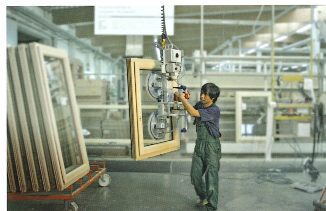
Vakuum-Hebegerät VacuMaster Window beim Entladen einer Verglasungspresse
