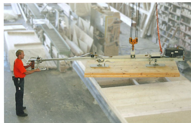
Vakuum-Hebegerät VacuMaster VHB bei der Handhabung von sägerauen Brettern und Bohlen
