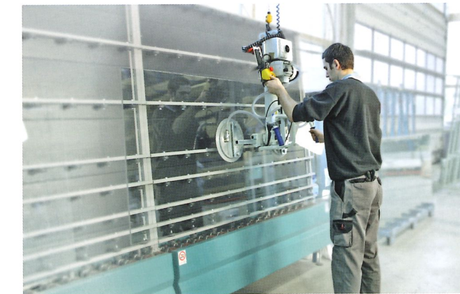
Vakuum-Hebegerät VacuMaster Window bei der vertikalen Handhabung einer Glasscheibe
