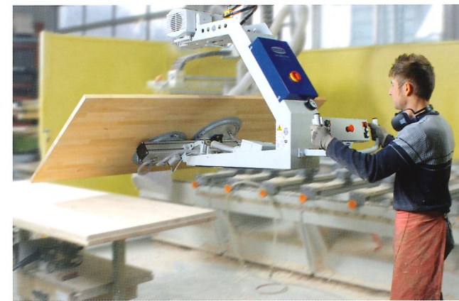
Vakuum-Hebegerät VacuMaster Comfort beim Wenden einer Holzplatte um 180°
