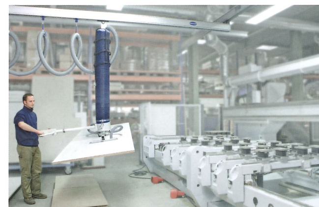
Vakuum-Schlauchheber JumboErgo bei der Beladung eines CNC-Bearbeitungszentrums
