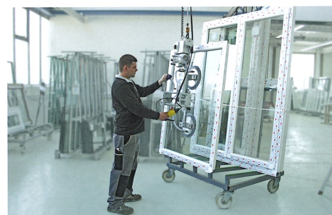
Vakuum-Hebegerät VacuMaster Window bei der Kommissionierung von Fenstern mit Kunststoffrahmen
