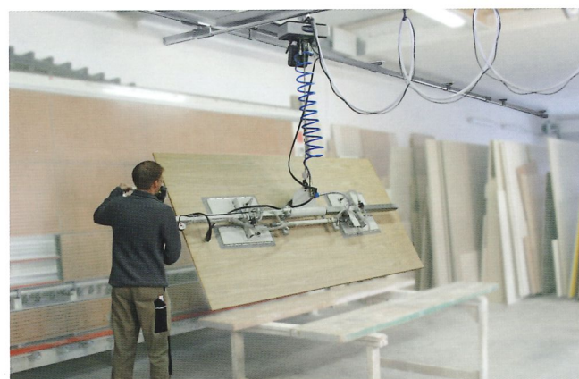
Vakuum-Hebegerät VacuMaster HHVM bei der Beladung einer stehenden Säge
