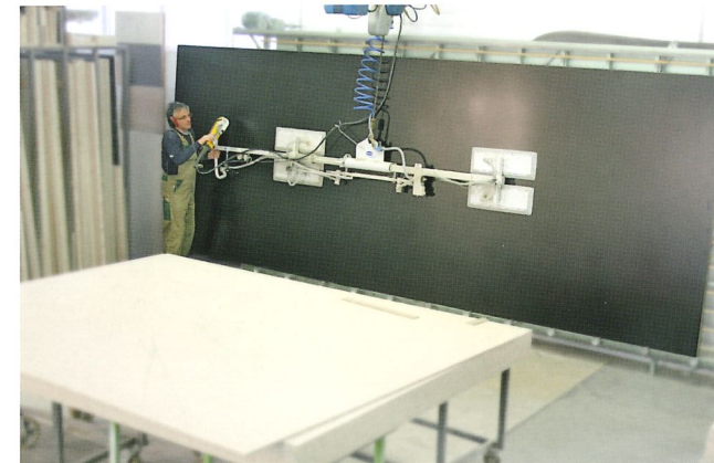
Vakuum-Hebegerät VacuMaster HHVM bei der Beladung einer stehenden Säge
