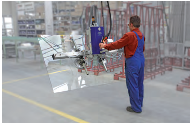
Vakuum-Hebegerät VacuMaster Basic beim Schwenken einer Glasscheibe um 90°
