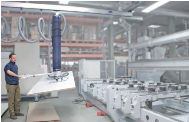
Vakuum-Schlauchheber JumboErgo bei der Beladung eines CNC-Bearbeitungszentrums
