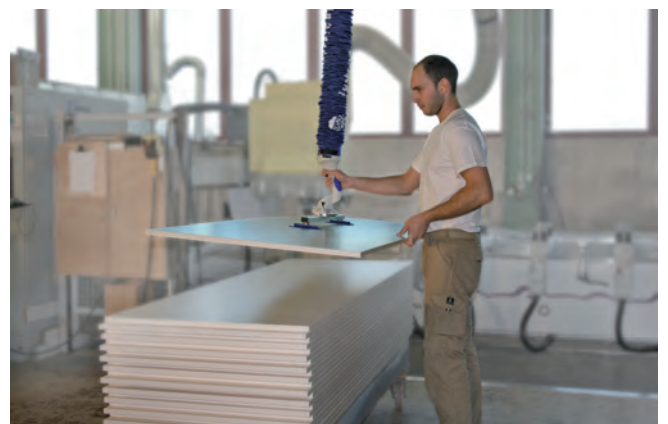
Vakuum-Schlauchheber JumboFlex bei der Handhabung von leichten, beschichteten Holzplatten bis 50 kg
