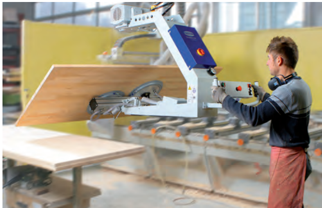
Vakuum-Hebegerät VacuMaster Comfort beim Wenden einer Holzplatte um 180°
