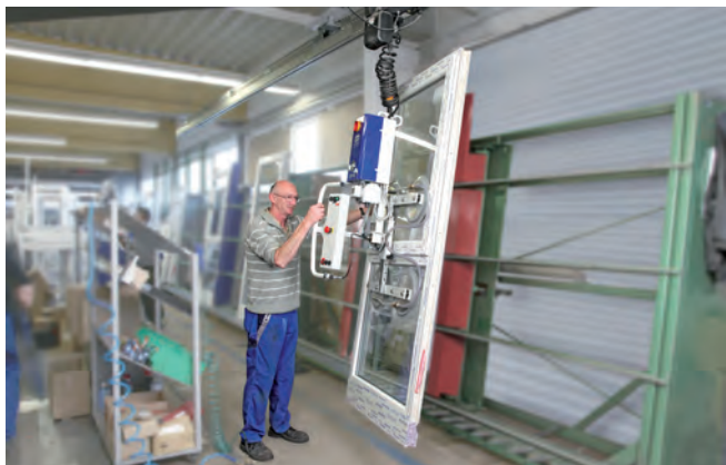
Vakuum-Hebegerät VacuMaster Window Comfort bei der Handhabung eines mehrflügeligen Fensters
