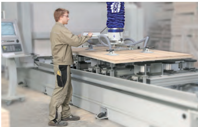
Vakuum-Schlauchheber JumboErgo bei der Beladung eines CNC-Bearbeitungszentrums
