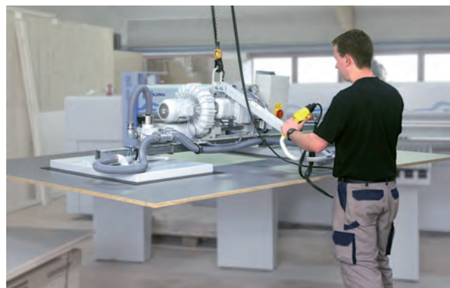
Vakuum-Hebegerät VacuMaster Multi mit zwei Saugplatten bei der Handhabung von schweren und porösen Holzplatten
